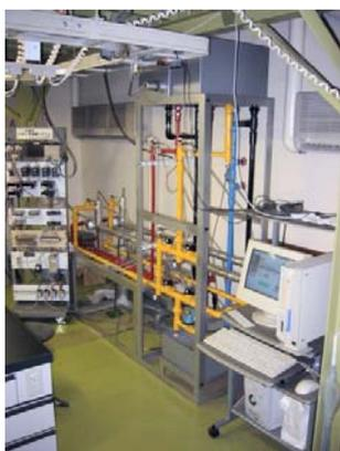
図7 二重管型熱交換器による伝熱実験装置
