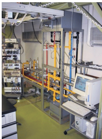
図 8: 二重管型熱交換器による伝熱実験装置
